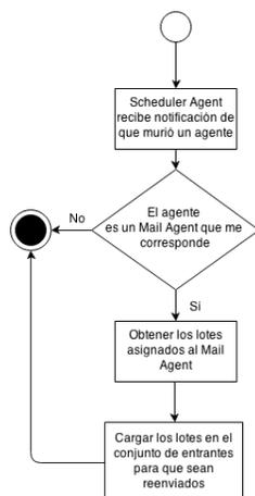
Figura 13: Algoritmo de Tolerancia a Fallas Capa 3
